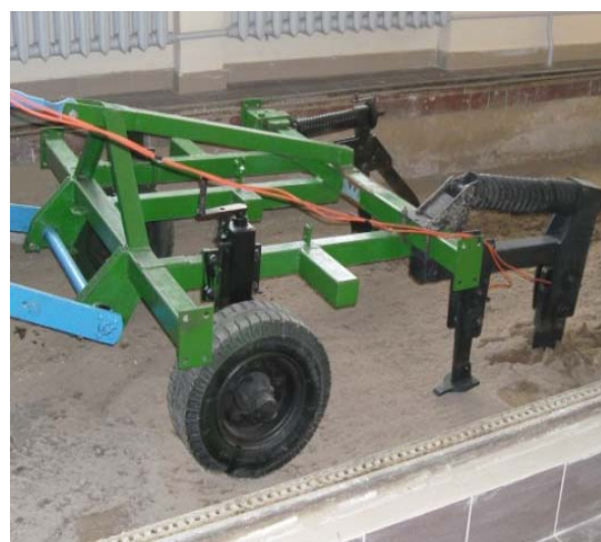
Рисунок 29 – Экспериментальный образец рабочего органа для глубокого безотвального послойного рыхления почв
