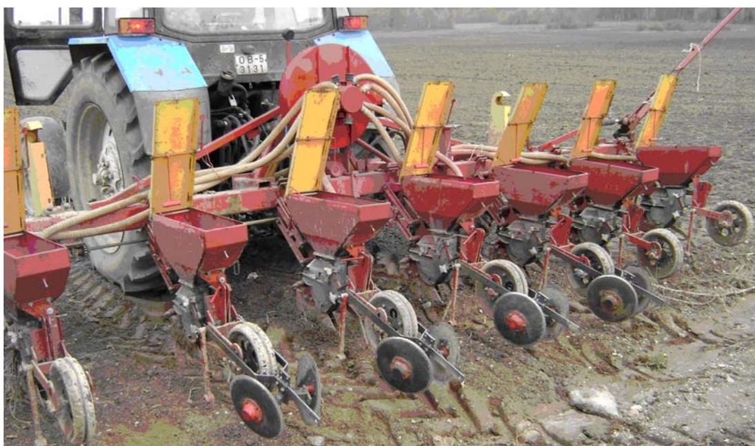
Рисунок 35 – Общий вид сеялки, оборудованной ГФУ
