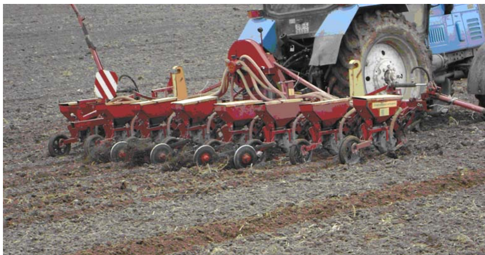
Рисунок 36 – Посев кукурузы сеялкой СТВ-8КУ, оборудованной ГФУ
