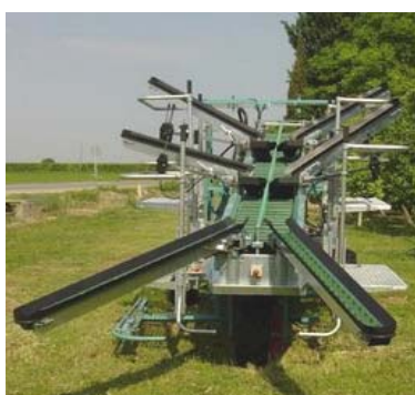
Рисунок 79 – Платформа плодуборочная «Pluk-O-Trak» фирмы «Munckhof» (Голландия)
