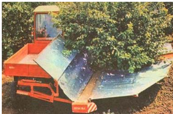
Рисунок 77 – Машина для уборки плодов косточковых культур ВУМ–15А
