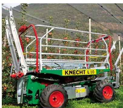
Рисунок 80 – Платформа плодуборочная «L10s pro» фирмы «Knecht» (Италия)
