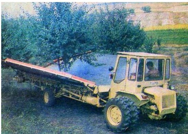
Рисунок 76 – Комбайн для уборки плодов МПУ–1А
