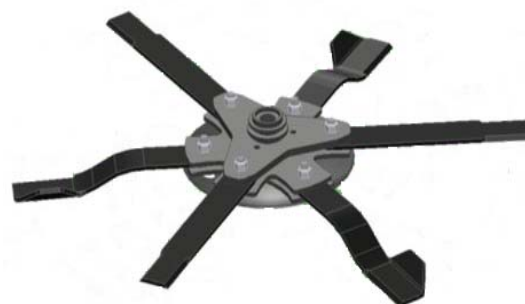
Рисунок 90 – Рабочий орган косилки-измельчителя SR 620 (Великобритания)
