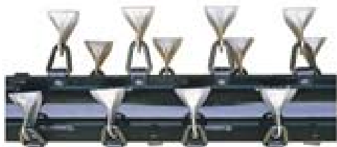
Рисунок 88 – Общий вид рабочего органа косилки-измельчителя WBS «SEPPI M» (Италия)
