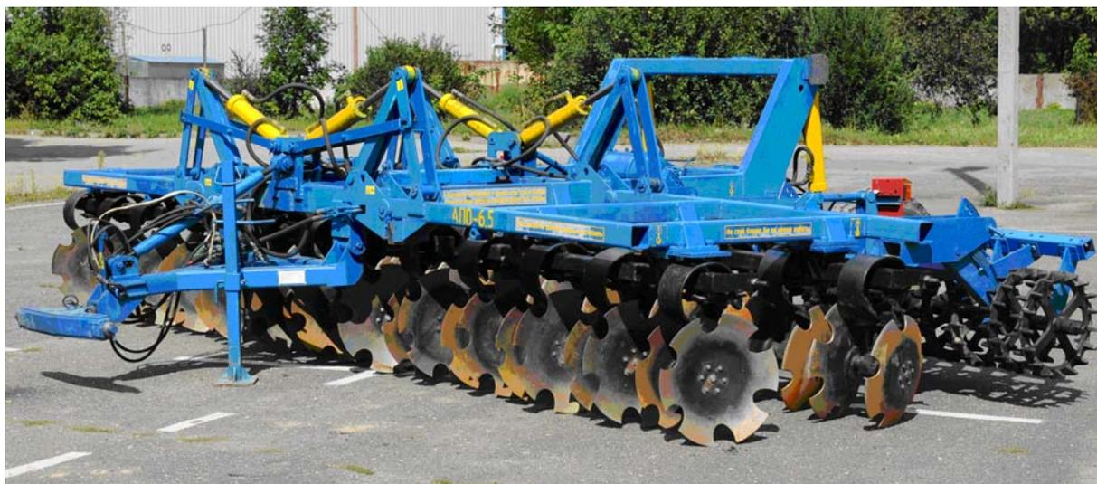
**Рисунок 114 – Общий вид экспериментального агрегата для лущения жнивья, доизмельчения и заделки в почву пожнивных остатков сельскохозяйственных культур АПО-6,5**
