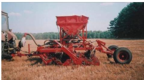
*Рисунок 5 – Сеялка зернотукотравяная прямого посева СПП-3,6*
