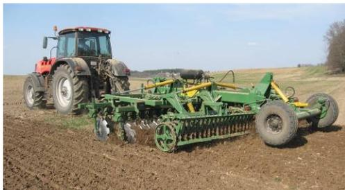
*Рисунок 1 – Агрегат почвообрабатывающий дисковый АПД-6*
