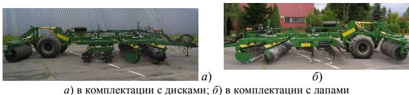
*Рисунок 3 – Агрегат почвообрабатывающий многофункциональный*
