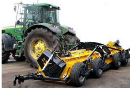
Рисунок 14 – Измельчитель стерни ИС-7.1
