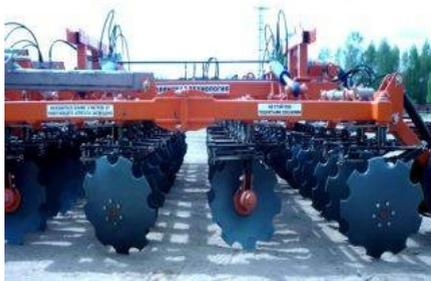
Рисунок 12 – Агрегат почвообрабатывающий дисковый АДУ-6 АКД
