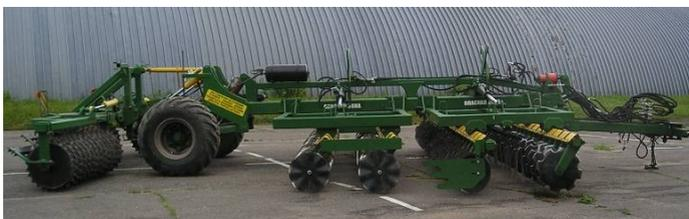
Рисунок 13 – Агрегат почвообрабатывающий многофункциональный АПМ-6
