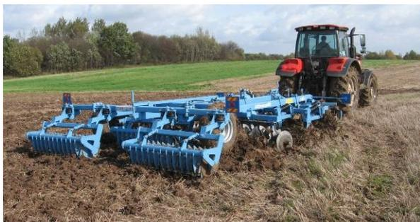
*Рисунок 24 – Агрегат для безотвальной обработки почв АБТ-4 в работе*
