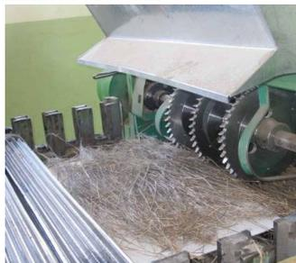
Рисунок 41 – Выходящий из слоеформирующей машины слой льнотресты
