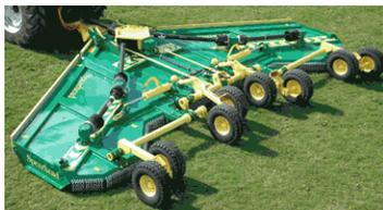
Рисунок 68 – Роторная косилка-измельчитель «Spearhead» Multi-Cut 620 (Дания)
