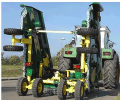
Рисунок 70 – Транспортное положение роторной косилки-измельчителя
