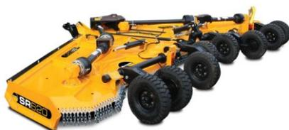
Рисунок 67 – Роторная косилка-измельчитель «McConnel» (Великобритания)
