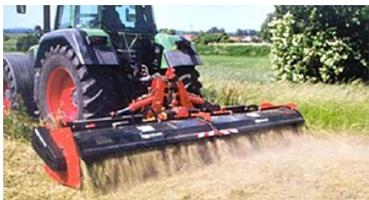
*Рисунок 64 – Общий вид косилки-измельчителя VN Master Cut TSL, «Отрана-М» (Беларусь)*
