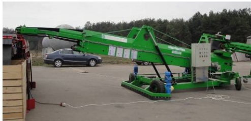
Рисунок 86 – Загрузчик телескопический ЗТ-40
