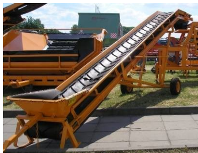
Рисунок 91 – Транспортер загрузочный ТВН-40
