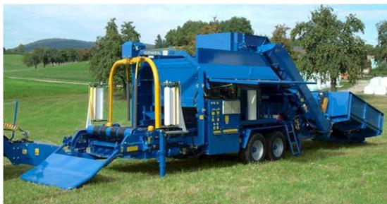
*Рисунок 123 – Комбинированный пресс-обмотчик «ЛТ-Мастер» (общий вид)*
