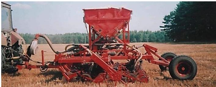
*Рисунок 44 – Сеялка зернотукотравяная прямого посева СПП-3,6*
