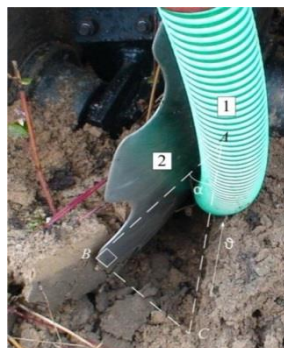
1 – разливочный шланг; 2 – сферический диск
