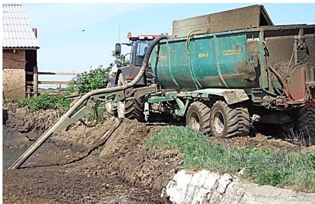
*Рисунок 64 – Машина МПН-16 на загрузке полужидкого навоза*
