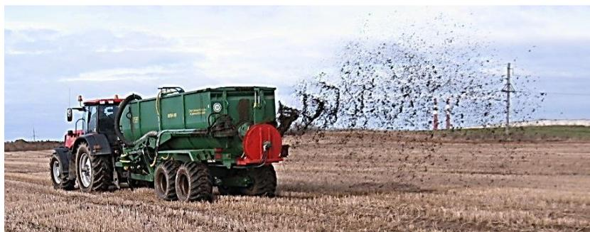
*Рисунок 65 – Машина МПН-16 в работе*
