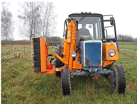
Рисунок 98 – Экспериментальный образец косилки-измельчителя КИО-1 при проведении исследовательских испытаний
