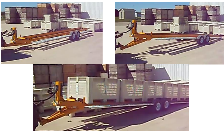
Рисунок 105 – Универсальный транспортировщик контейнеров Carro raccolta bins фирмы «Romani Roberto», Италия
