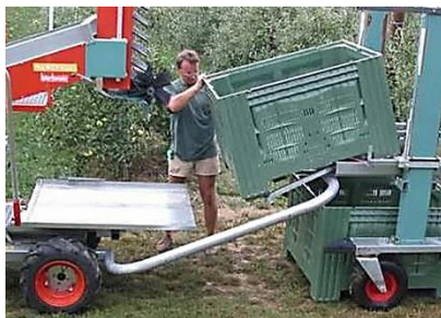
Рисунок 104 – Установка пустого контейнера
