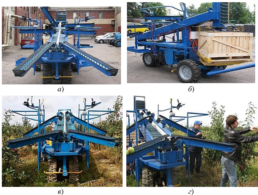
а – вид спереди; б – вид сзади сбоку; в, г – уборка плодов посредством агрегата Рисунок 102 – Агрегат самоходный универсальный с поточным контейнеровозом для сбора плодов и формирования кроны семечковых культур АСУ-6
