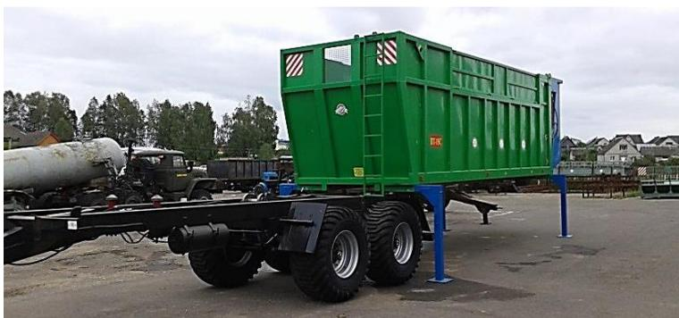
*Рисунок 23 – Установка цельнометаллического кузова на унифицированных шасси*
