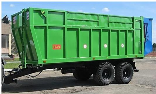
**Рисунок 22 – Полуприцеп тракторный самосвальный ПТ-15С и унифицированное двухосное шасси**
