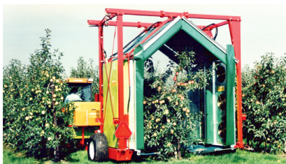
Рисунок 5. – Опрыскиватель Wine Tunnel в работе
