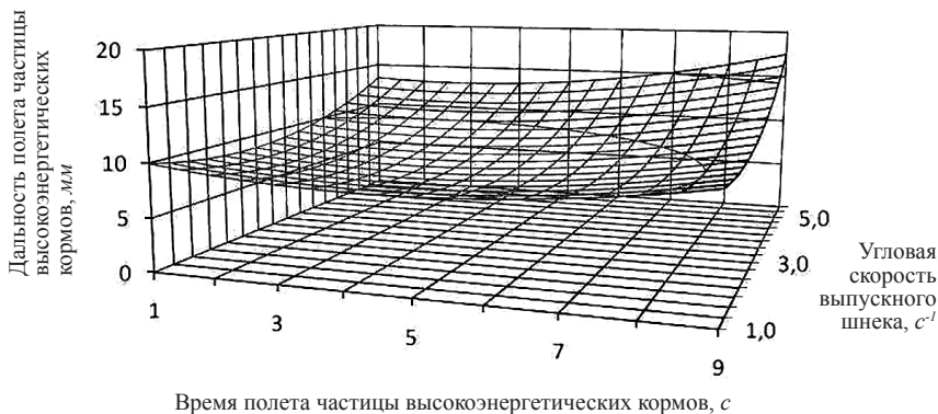
Рисунок 2. – Зависимость дальности полета частицы высокоэнергетических кормов от времени полета и угловой скорости шнека
