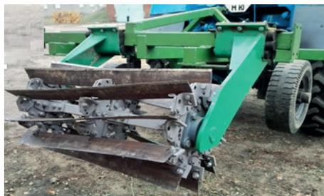
**Рисунок 1. – Экспериментальная установка спирально-ножевидного катка**
