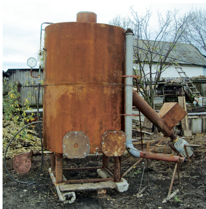
Рисунок 3. – Ферментер и установка для подачи органической массы
