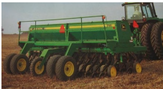
Рисунок 5 – Сеялка прямого подсева трав в дернину
