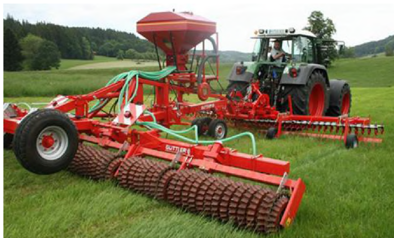
Рисунок 4 – Агрегат комбинированный по уходу за лугопастбищными угодьями
