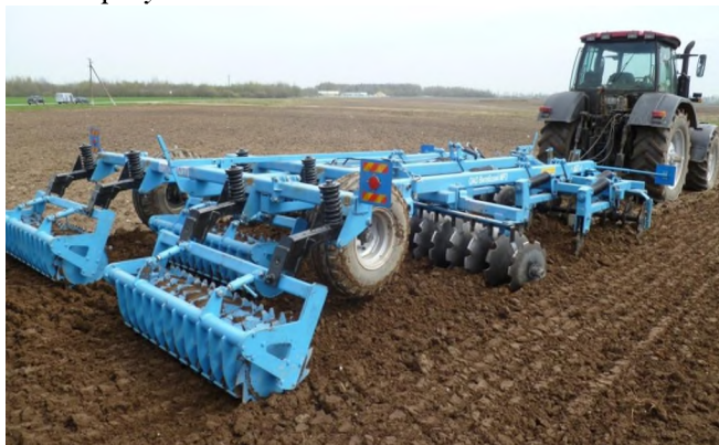
Рисунок 39 – Агрегат для безотвальной обработки почв АБТ-4 с трактором «Беларус-3022.1» на весенней обработке зяби
