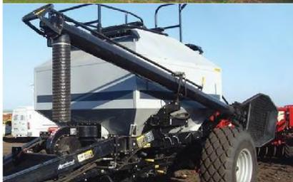
**Рисунок 49 – Трехсекционный бункер с загрузочным устройством**
