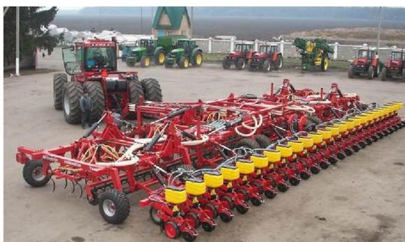
*Рисунок 46* – Почвообрабатывающе-посевной агрегат «Terminator» фирмы «Hatzenbichler» с секциями для посева пропашных культур
