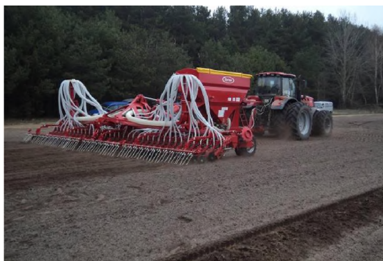
Рисунок 63 – Сеялка пневматическая С-9 с трактором «Беларус-3022» при выполнении технологического процесса посева зерновых культур
