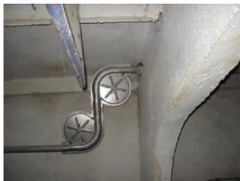
*Рисунок 51 – Поворотные устройства линии раздачи корма*
