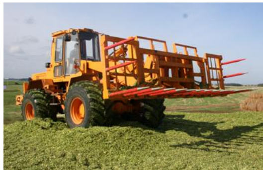
Рисунок 7. – Агрегат для распределения силосной массы в траншее АЗВК
