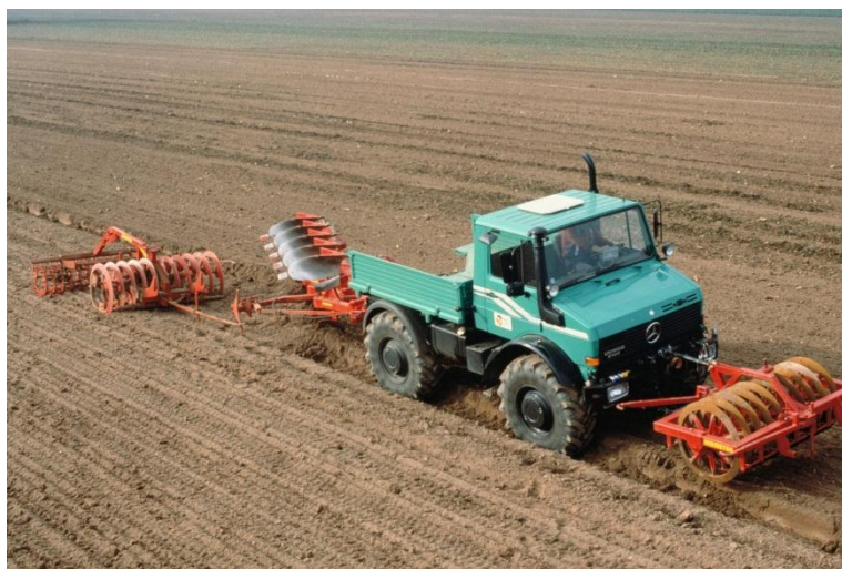
Рисунок 1. – Универсальное энергетическое средство Unimog
