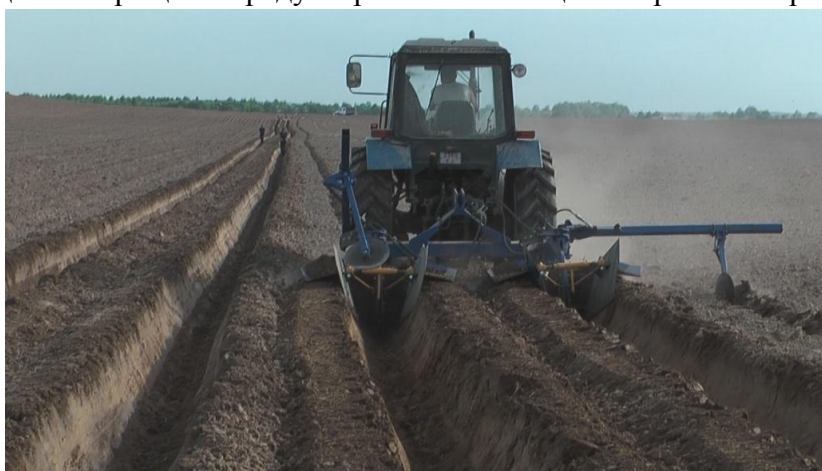
Рисунок 3. – Нарезка рядов рядовым делателем ГН-1
