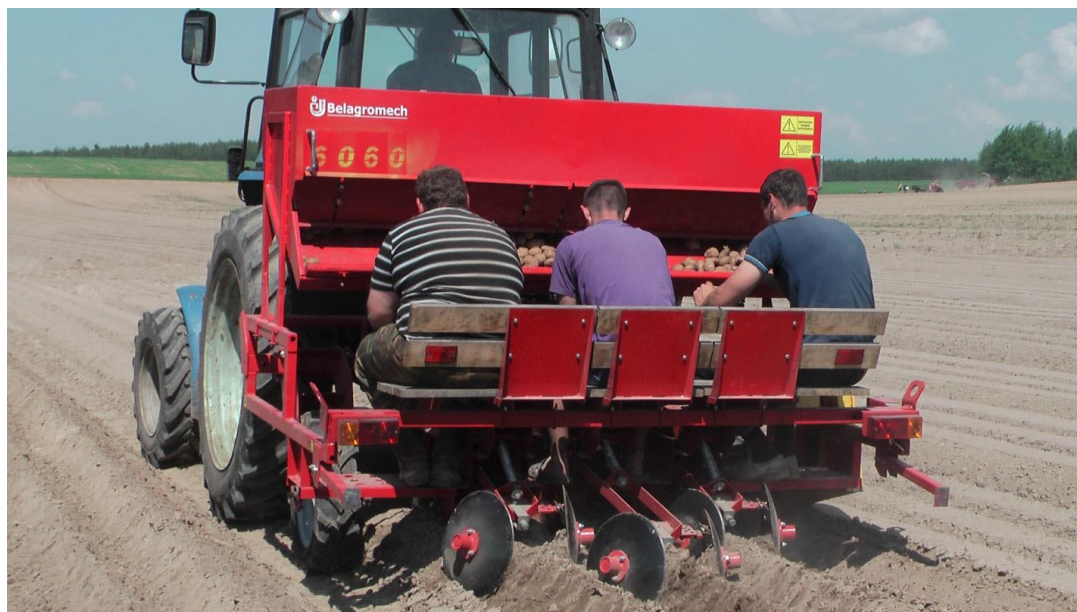
Рисунок 4. – Сажалка револьверного типа СГР-1 в рабочем положении
