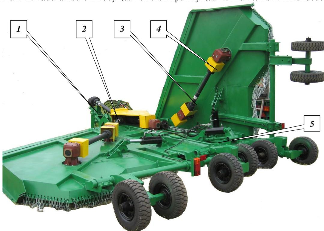
1 – карданный вал; 2 – центральный редуктор; 3 – приводной карданный вал;
