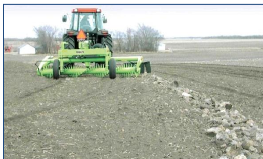
Рисунок 1. – Вид валкователя в работе и образуемый им валок камней
