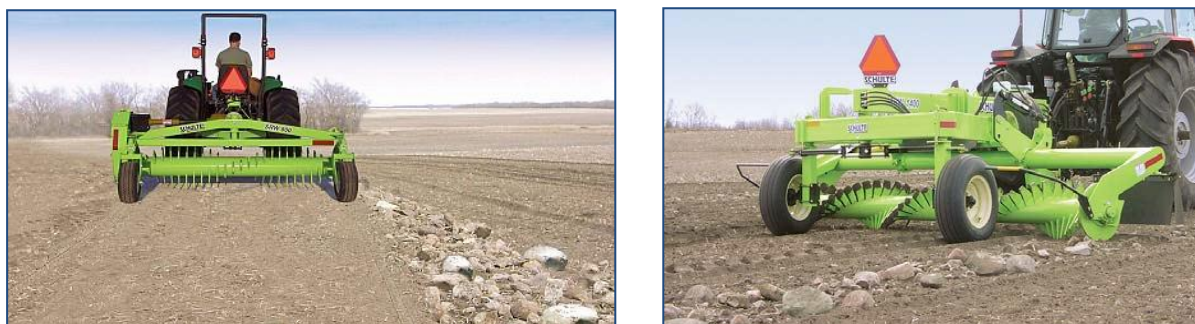
а – валкователь SRW 800; б – валкователь SRW 1400 Rock Windrower
