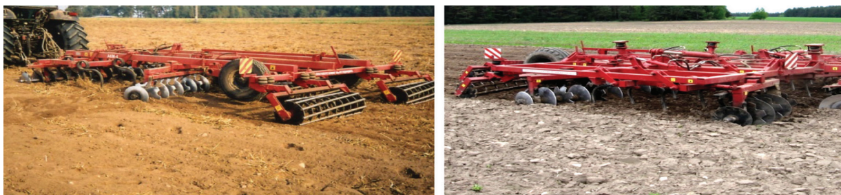
Рисунок 1. – Агрегаты комбинированные для минимальной обработки почв АКМ-4 (а) и АКМ-6 (б) производства ГП «Экспериментальный завод» РУП «НПЦ НАН Беларуси по механизации сельского хозяйства»
