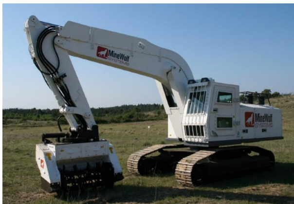
Рисунок 3. – Фреза-планировщик на базе гусеничного экскаватора фирмы MineWolf (Германия)
