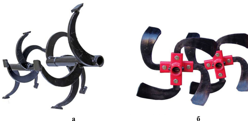
а) рабочий орган с бильными ножами; б) рабочий орган с лопастными ножами
