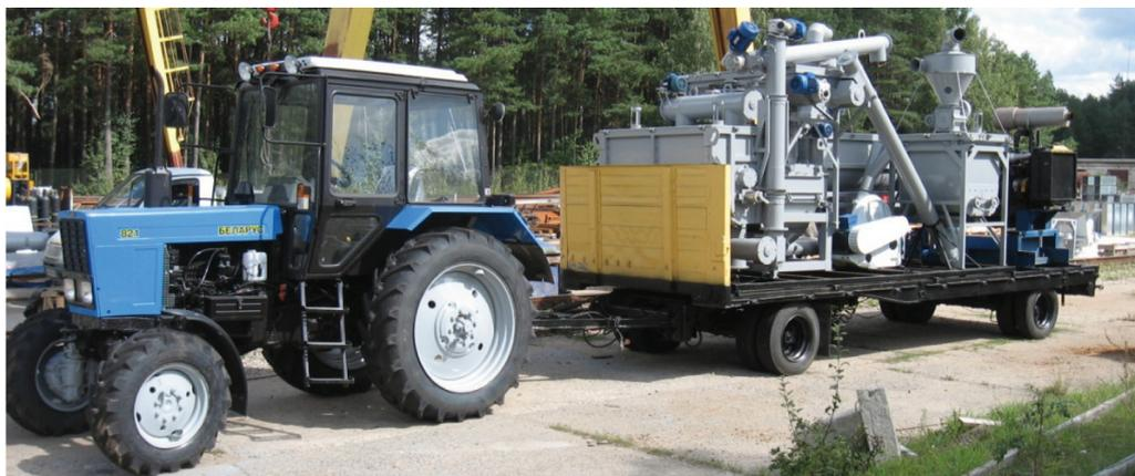
Рисунок 7. – Мобильный комбикормовый завод производительностью 4 т/ч
