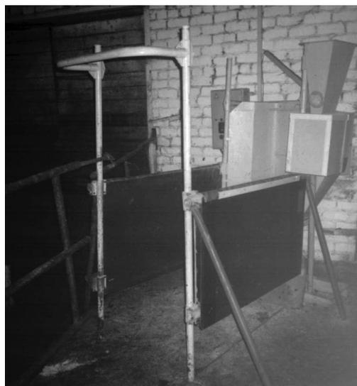
Рисунок 6. – Автоматизированная станция кормления СКА-25
