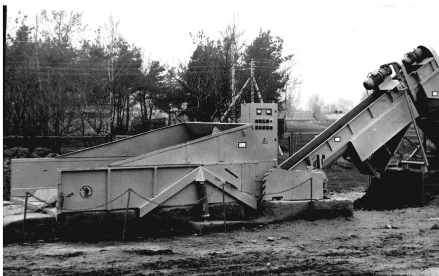
Рисунок 4. – Линия сухой очистки корнеплодов с сухим способом отделения посторонних примесей ЛОК-10
