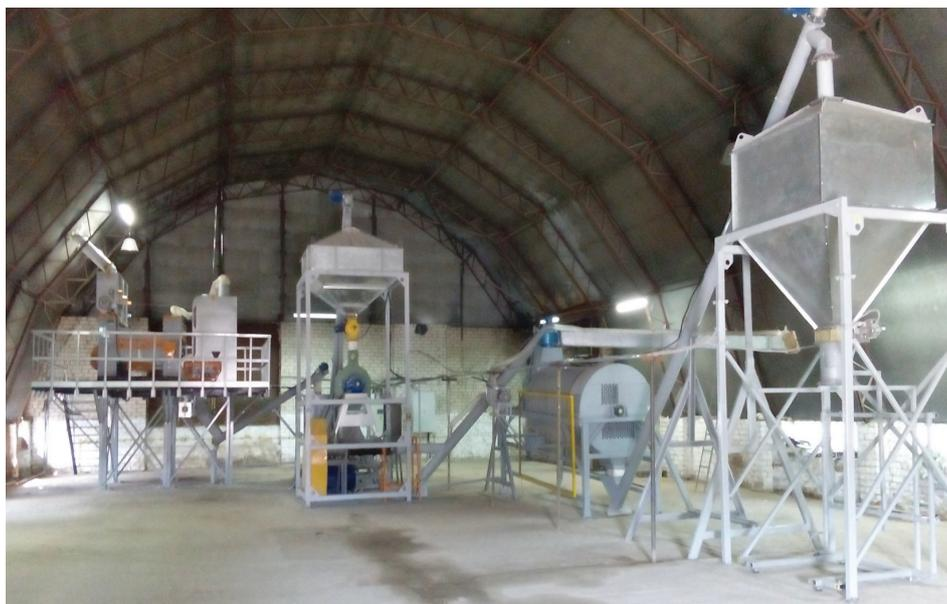
Рисунок 1. – Комплект оборудования для получения высокоусвояемого экструдированного корма на основе бобовых культур и зерна кукурузы КОЭК-1
