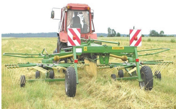
Рисунок 3. – Грабли-валкователи с центральным расположением валка ГВЦ-6,6
