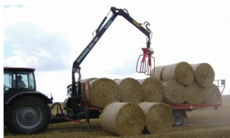
Рисунок 5. – Платформа с манипулятором для подбора, перевозки и скирдования рулонов и тюков ПМК-10
