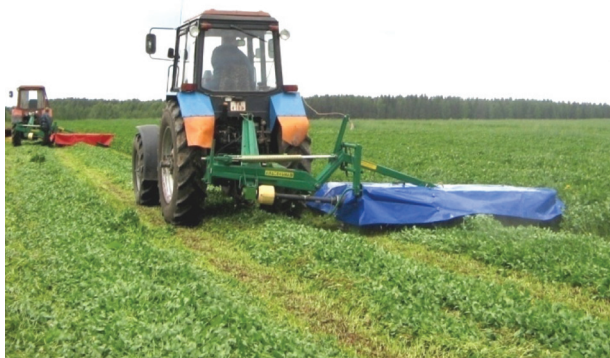
Рисунок 1. – Косилка дисковая навесная КДН-3,1
