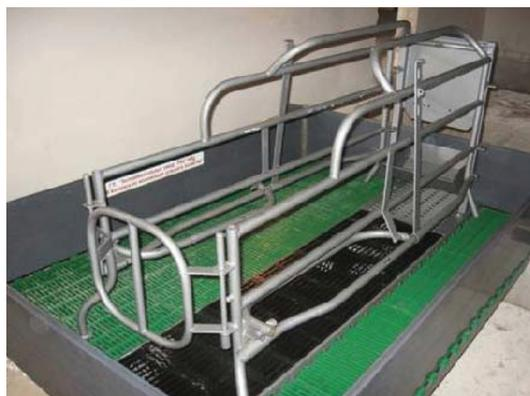
Рисунок 8. – Станок для опоросов свиноматок СОП-1
