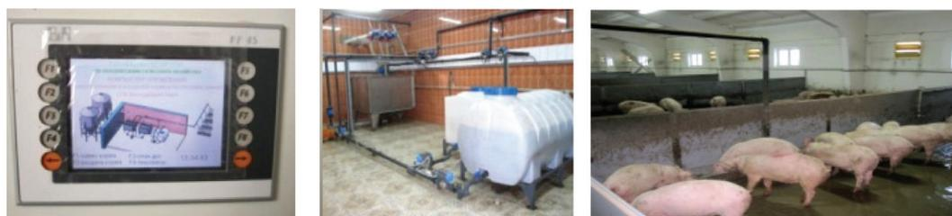
Рисунок 10. – Комплекс оборудования для жидкого кормления КОЖК с системой компьютерного управления технологическим процессом с возможностью удаленного доступа
