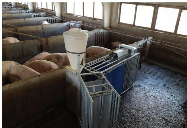
Рисунок 11. – Станция автоматизированная для индивидуального кормления свиноматок САИК
