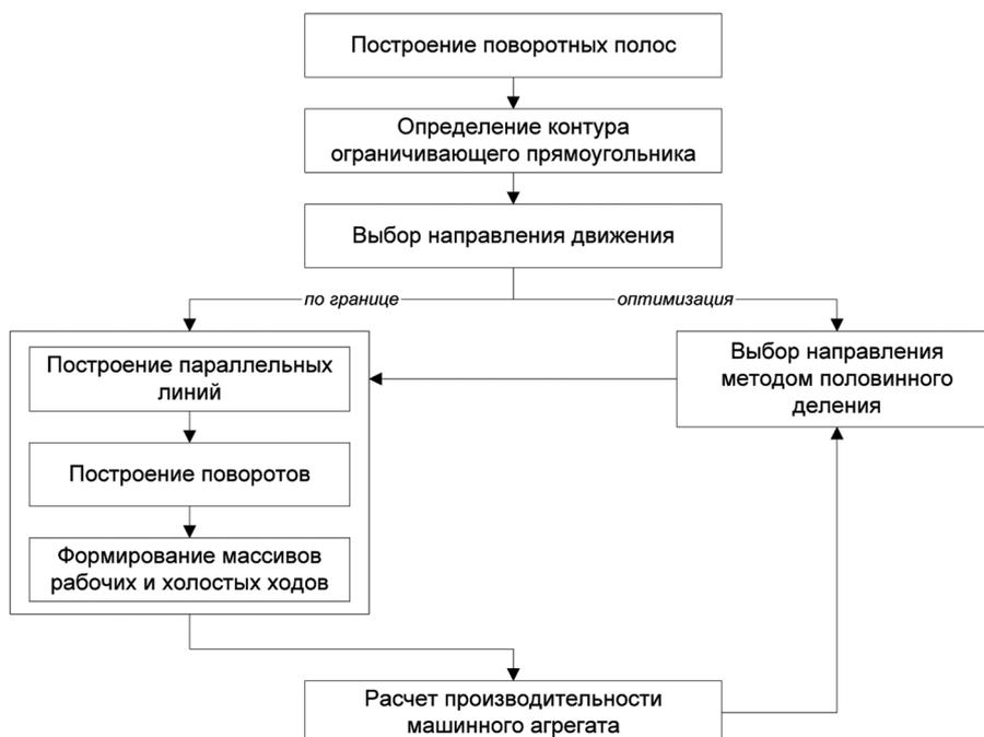
Рисунок 10. – Алгоритм построения траектории движения машинного агрегата
