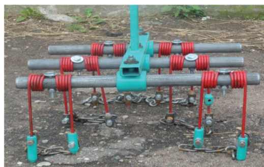
Рисунок 1. – Пружинный рыхлитель для механического уничтожения сорняков
