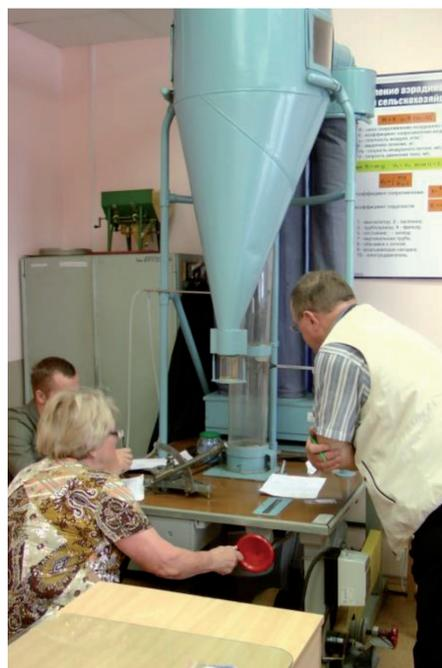
Рисунок 5. – Определение коэффициента парусности и скорости витания
