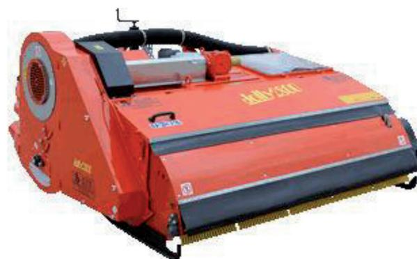
Рисунок 4. – Прицепной комбайн Jolly 1800 (Италия) производительностью 1000 кг/ч
