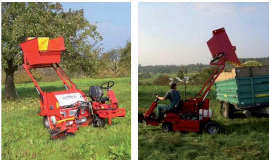
Рисунок 1. – Самоходная машина ОВ 80R для сбора падалицы яблок, орехов, сливы и груши
