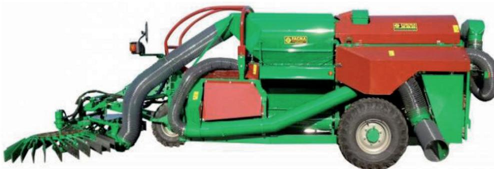
Рисунок 3. – Прицепной комбайн Cimina C380T (Италия) производительностью 2 т/ч
