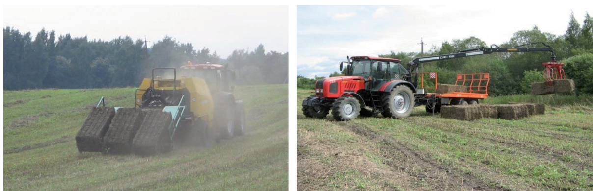
Рисунок 5. – Группирование (а) и погрузка сгруппированных тюков на платформу ПМК-10 (б)
