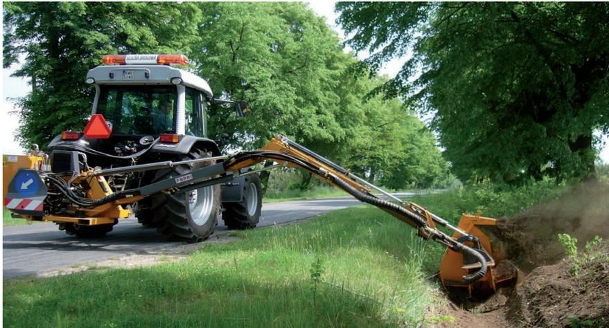
Рисунок 1. – Роторный каналоочиститель Rolmex ditch cleaner PR80 (Польша)
