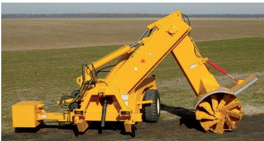
Рисунок 3. – Каналоочиститель Hurricane Original Side Arm Ditcher (США)
