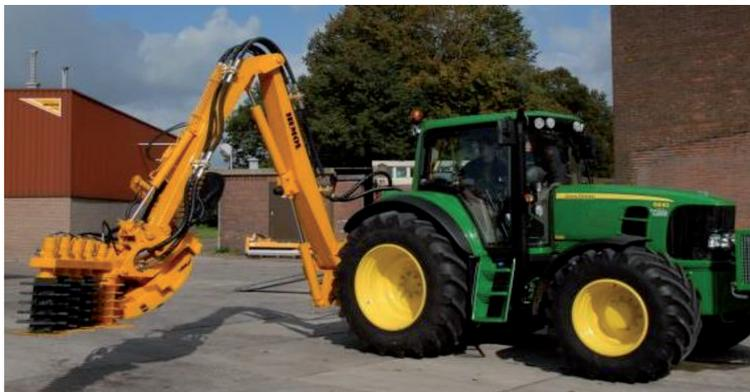
Рисунок 4. – Каналоочиститель фрезерный с дробилкой Nemos 1600ST (Нидерланды)
