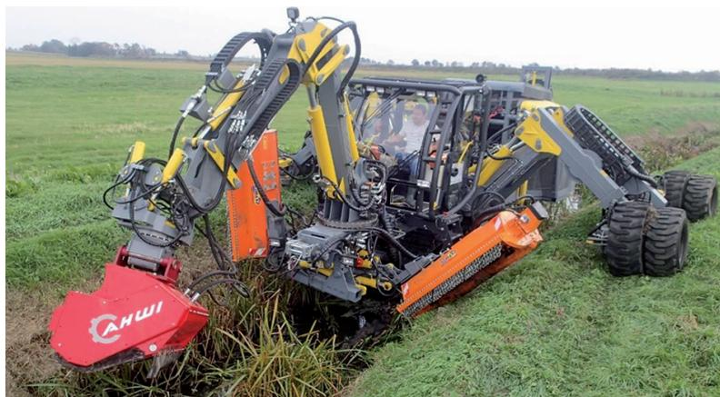
Рисунок 7. – Прототип мелиоративного комбайна в канале
