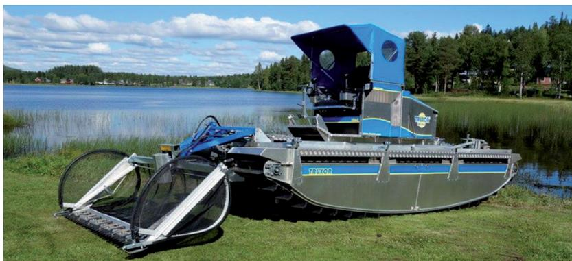
Рисунок 10. – Многофункциональная самодвижущаяся установка Truxor DM 5000 (Швеция)
