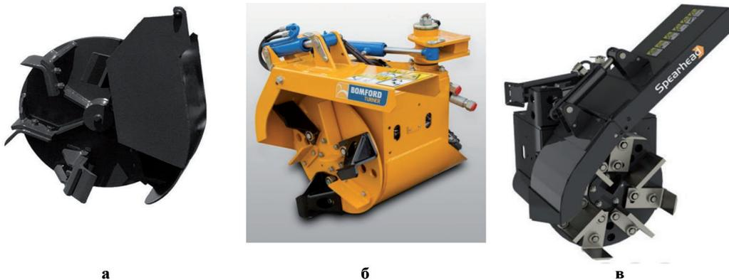
Рисунок 2. – Роторные рабочие органы каналоочистителей: (а) GreenTec GR 70 (Дания);
