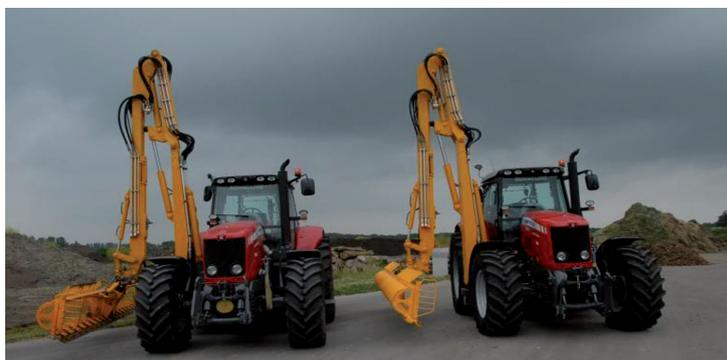
Рисунок 6. – Каналоочистители со специализированными ковшами
