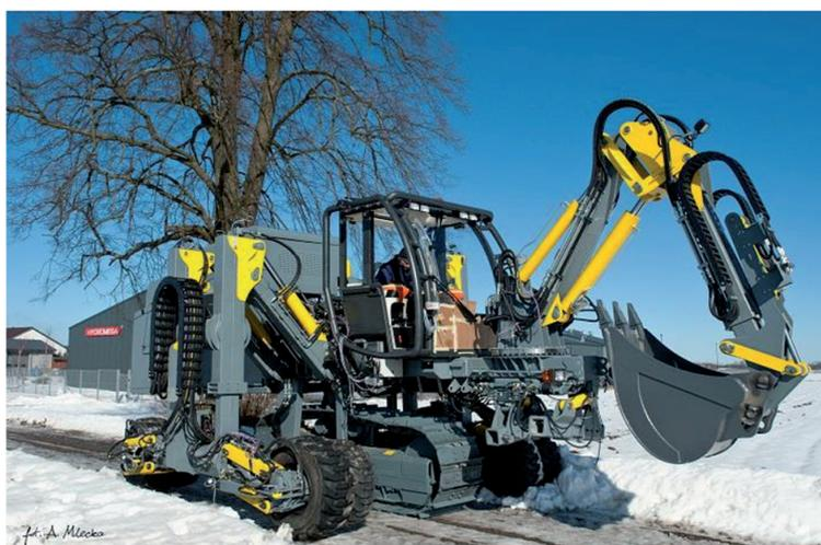
Рисунок 8. – Прототип мелиоративного комбайна в транспортном положении
