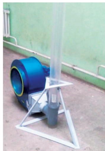
1 – вентилятор; 2 – труба; 3 – опора; 4 – тройник; 5 – заглушка; 6 – переходник; 7 – вкладыш
