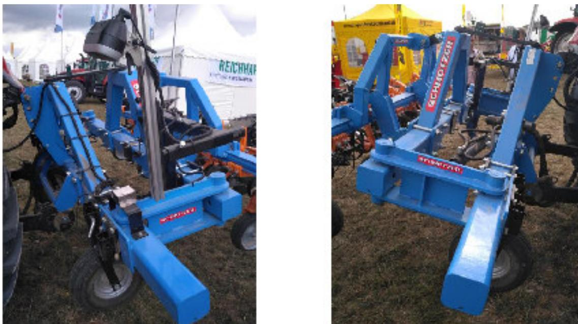
Рис. 2. – Система точного вождения фирмы Maschinenfabrik SCHMOTZER GmbH, Германия
