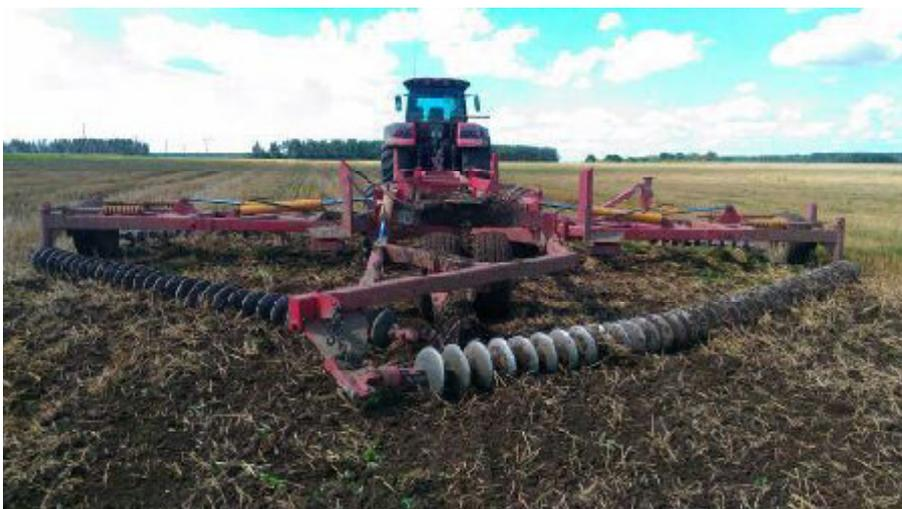
Рис. 3. – Луцильник дисковый ромбовидный ЛДР-9 в рабочем положении
