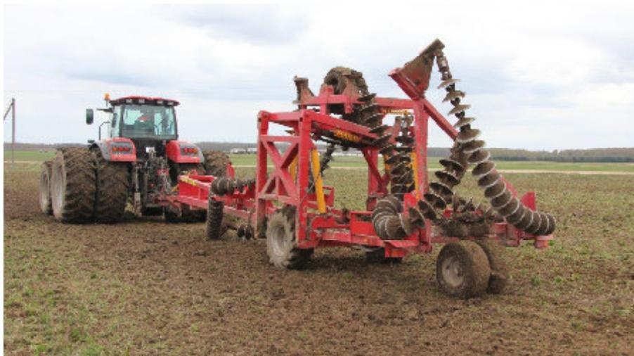
Рис. 2. – Луцильник дисковый ромбовидный ЛДР-9 в транспортном положении
