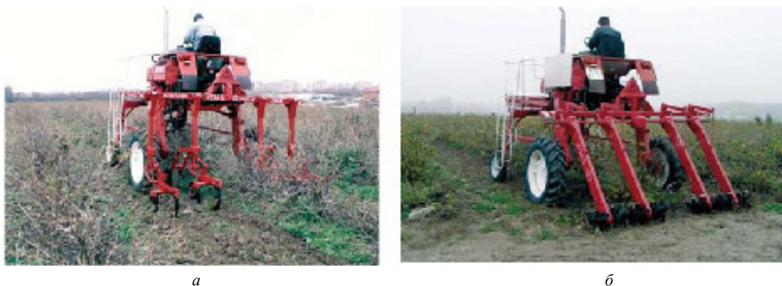
а – пропашной культиватор КП-4 (КСМ-5-03); б – фрезерный культиватор КФ-4 (КСМ-5-02)
