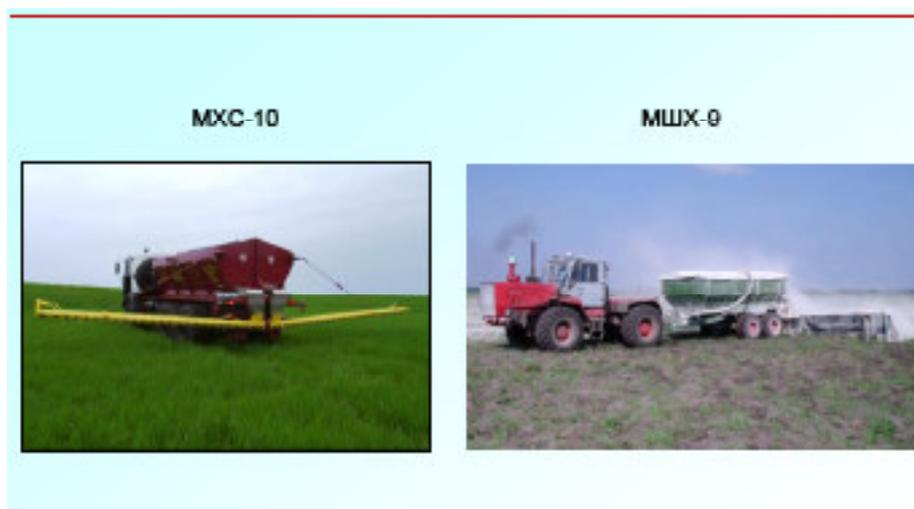
Рис. 1. Комплекс машин для применения известковых материалов
